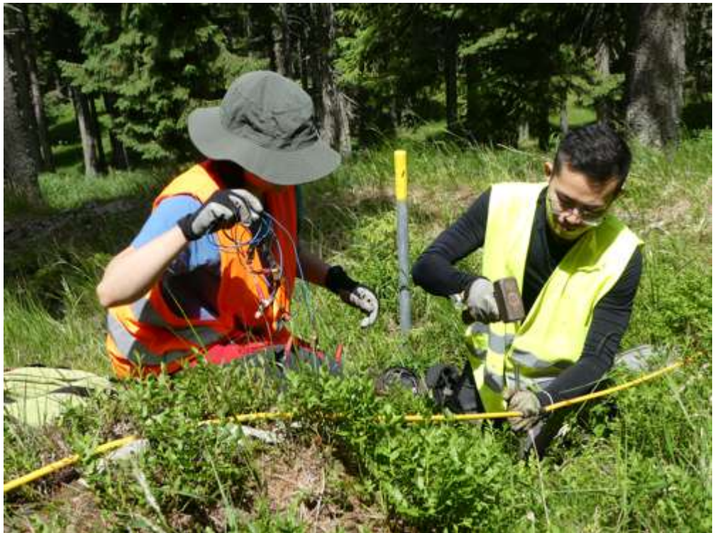
Foto: Patrícia Caixeta Borges und Haoyang Zhou beim Setzen von Elektroden für induzierte Polarisierungsuntersuchungen im Explorationsgebiet von Wolfsberg, Österreich.
